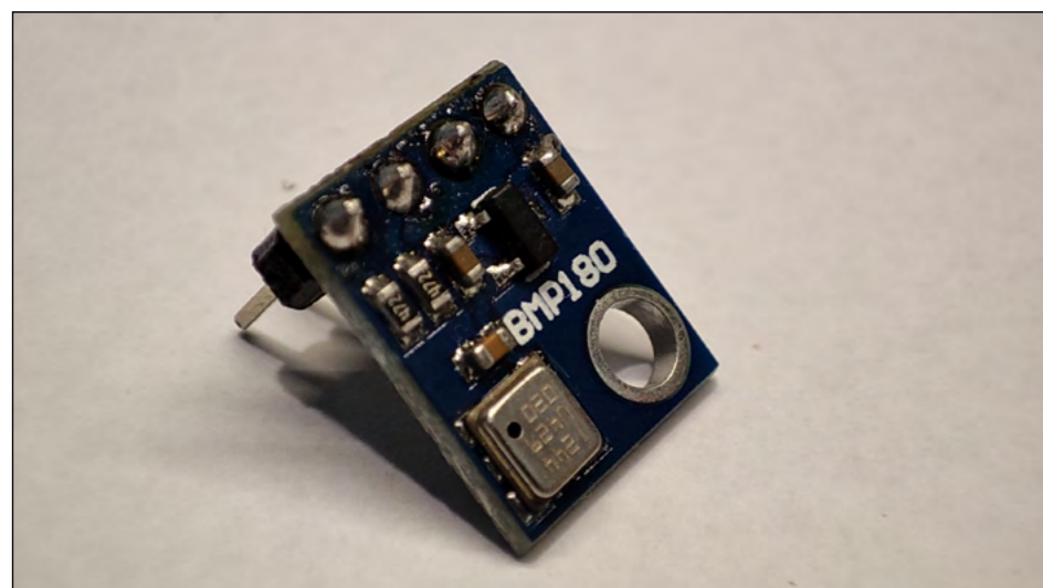
Obrázek 9: Modul čidla BMP180
