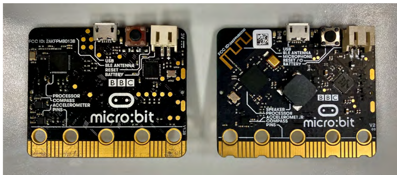
Obrázek 2: Zadní strana micro:bitu, vlevo V1, vpravo V2
