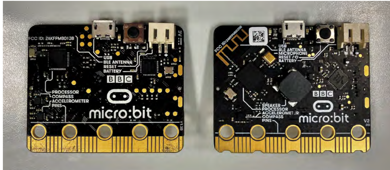
Obrázek 2: Zadní strana micro:bitu, vlevo V1, vpravo V2
