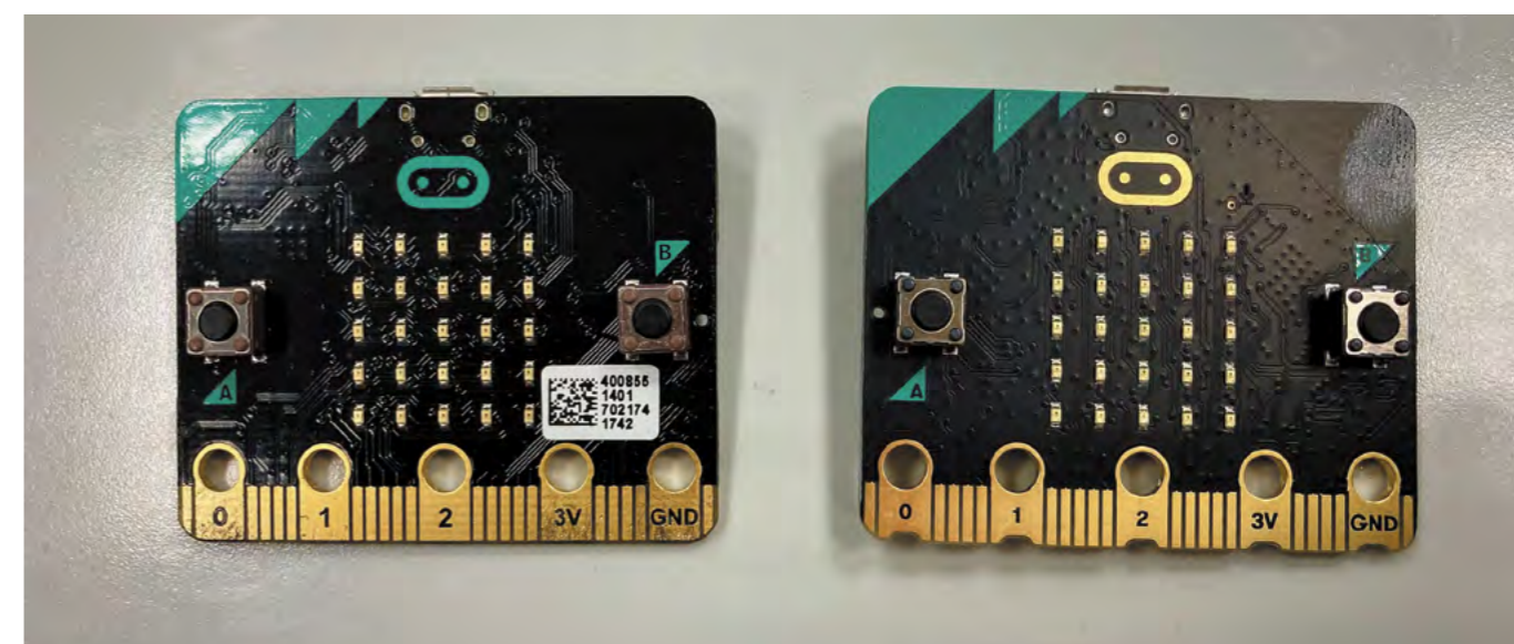
Obrázek 1: čelní strana micro:bitu, vlevo V1, vpravo V2
