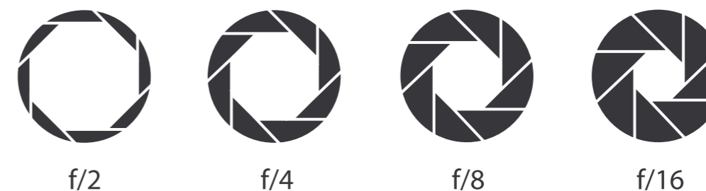
Obr. 1 – Příklad nastavení clony objektivu
