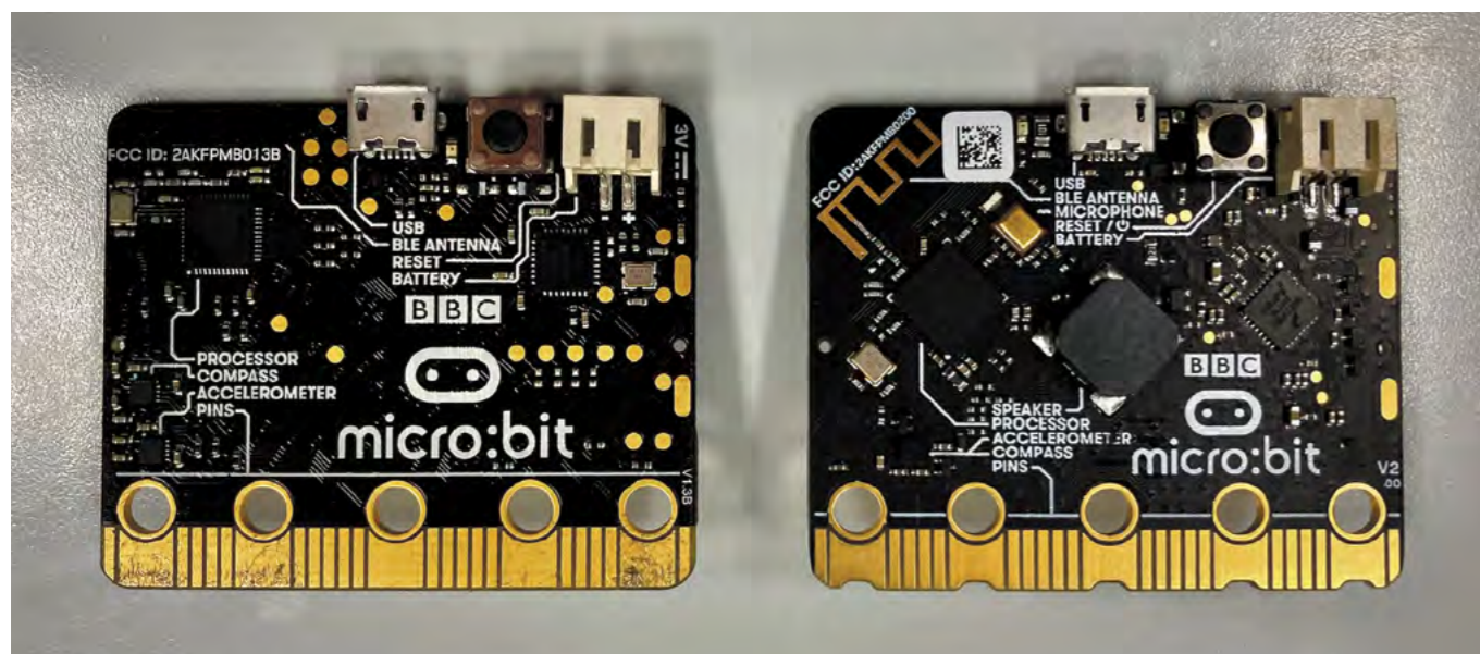
Obrázek 2: Zadní strana micro:bitu, vlevo V1, vpravo V2
